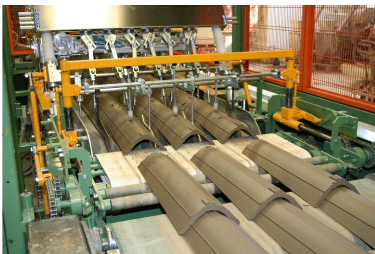
TAGLIERINA MODELLO C12 ELETTRONICA IN FUNZIONE CON TAGLIO DENTELLO A TRE USCITE
